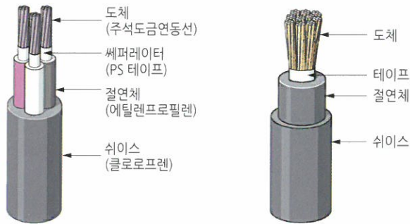
그림 5-10 캡타이어 케이블(좌)와 용접용 케이블(우)
