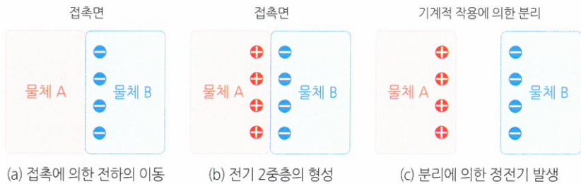
그림 4-2 정전기 발생 구조
