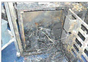
그림 6-4 실험실내 바이오매스 가스화 장치의 판넬부 과열
