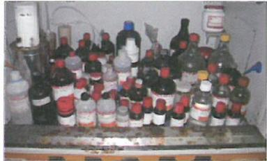
그림 3-12 사고 보도 및 시약장으로 변한 흡 후드의 모습
