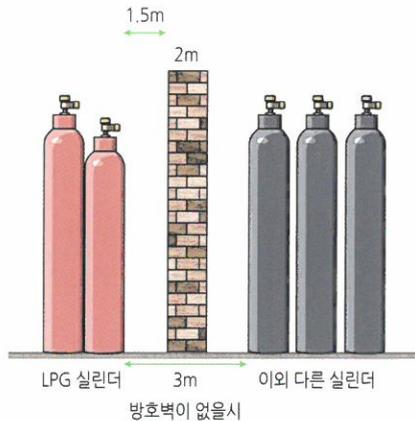
그림 2-5 방호벽 설치의 예(3m 이상 분리를 원칙으로 함)
