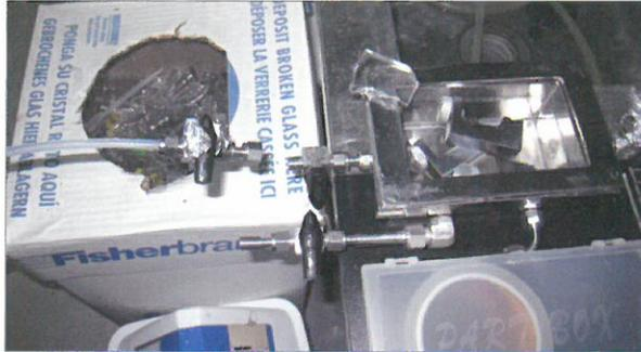
그림 3-30 가스 과잉 공급으로 인한 챔버 파열
