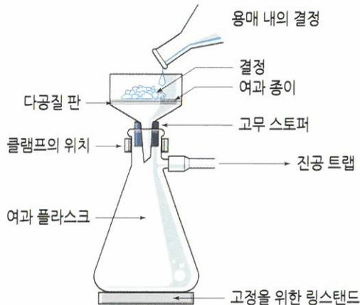
그림 1-20 감압여과장치를 이용한 재결정 실험장치의 예
