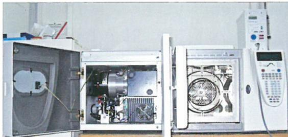
그림 1-26 GC 내부 오븐 및 컬럼의 모습
